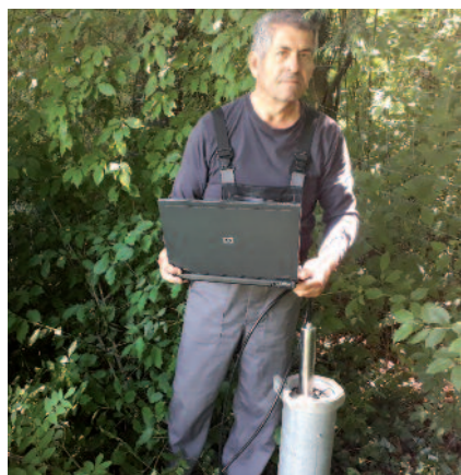
Kontrolle der Messsonde an der Grundwassermessstelle Forsthaus Orth
